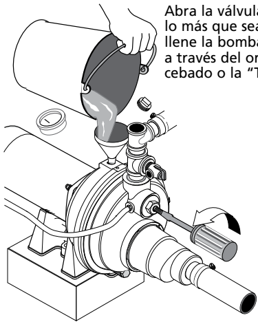
Figura 16 – Abra la Válvula de Control
